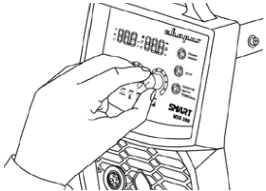
Рис. 9.19. Установка параметров сварки
