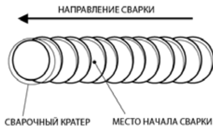
Рис. 12.4. Начало сварки при смене электрода.
